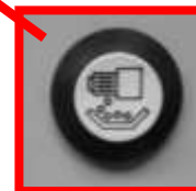
Rys. N°17: przycisk na siewniku do uruchomienia próby kręconej
