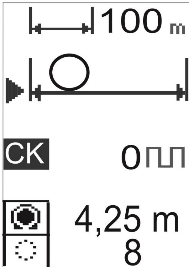
Rys. 13 Kalibracja obwodu koła
