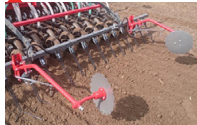
Ścieżki technologiczne przedwschodowe, hydrauliczne.
