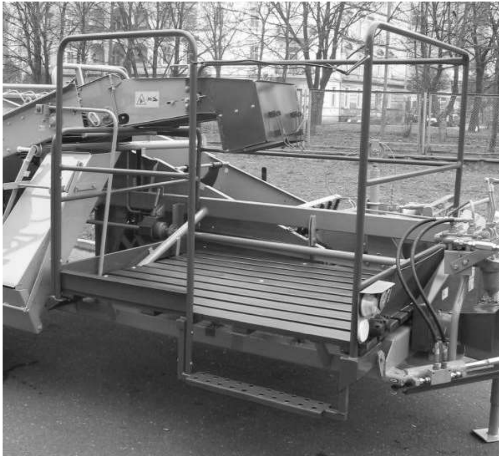
Rys. 27 Kombajn z zamontowaną platformą i workownicą
