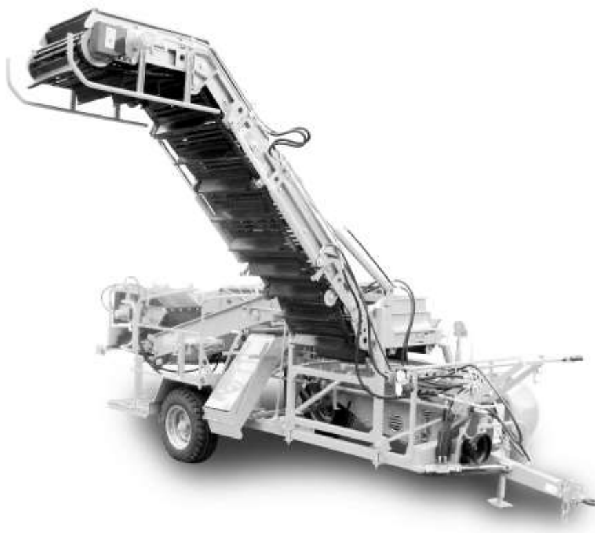
Rys. 28 Kombajn z zamontowanym przenośnikiem ładującym
