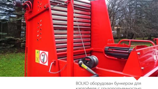
Высота выгрузки составляет от 1350 до 2700 мм. Выгрузка выполняется во время простоя после пуска ленты напольного транспортера.
