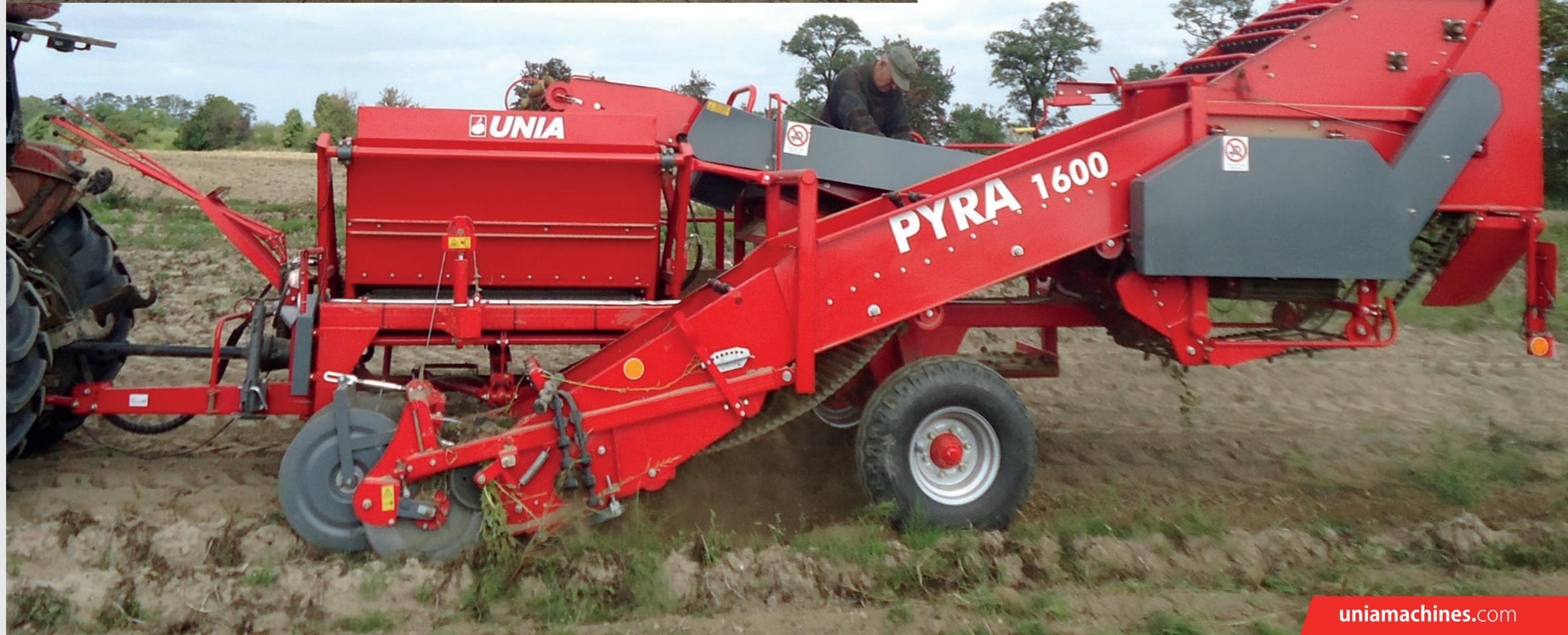
„Dank des kompakten Baus, besitzt die Vollerntemaschine ein sehr geringes Eigengewicht, wodurch ihr Kraftbedarf nur ca. 60 PS beträgt. Die hydraulisch gesteuerte Deichsel erleichtert das Manövrieren mit der Maschine während der Arbeit und beim Entladen.“
