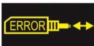
Rys. 8 Błąd pracy siłownika
