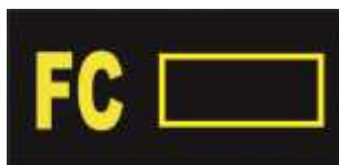
Rys. 7 Sprawdzenie czujnika licznika
