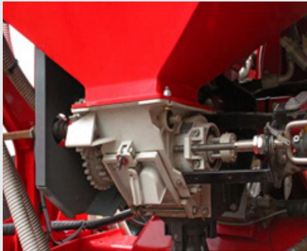
Das moderne, universelle Aussaatapparat FX garantiert eine wiederholbare Aussaat in einer Dosis von 1,8 bis 400 kg/ha. Der Apparat wird zur Aussaat von sowohl feinem als auch grobem Saatgut verwendet, ohne dass die Säwalzen ausgetauscht werden müssen. Die einfache Regulierung und präzise Einstellung sorgen für eine problemlose Saatgutabgabe. Der Apparat verfügt über ein schnelles System zum Entleeren der verbleibenden Samen.
