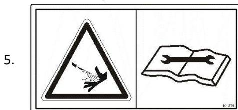
Unter Druck austretende Flüssigkeiten (Hydrauliköl) können in die Haut eindringen und schwere Verletzungen verursachen! Bei Verletzungen sofort einen Arzt aufsuchen! Infektionsgefahr!
