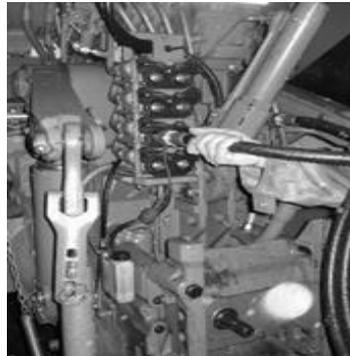
Abb. 3 Anschließen der Hydraulik.
